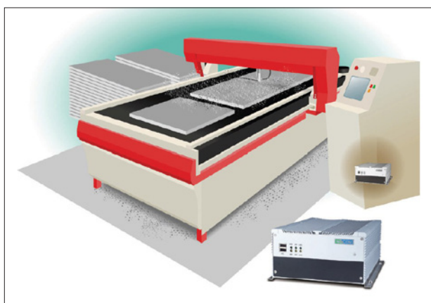
Obr. 1. Základem řídicího systému řezacího stroje pro firmu Kingspan je průmyslový vestavný počítač NISE3142P
