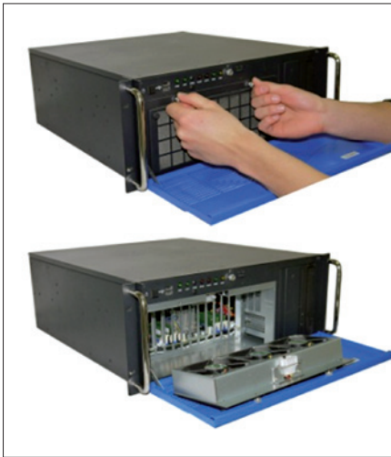
Obr. 3. Servery KISS jsou vybaveny redundantními ventilátory; v případě oprávněného podezření blížící se poruchy ventilátoru je jeho výměna velmi snadná – ventilátor je přístupný z čelní strany a pro jeho výměnu není třeba server odstavovat
