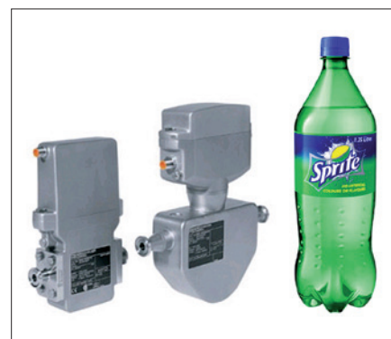
Obr. 3. Průtokoměry pro odměřování dávek při plnění Dosimag a Dosimass jsou důležité zvláště u PET lahví, jejichž rozměry jsou velmi variabilní a nelze u nich použít odměřování množství odvozené od polohy hladiny v lahvi
