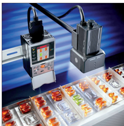
Obr. 1. Kamerové snímače ZFV od společnosti Omron, vhodné například pro kontrolu výroby
