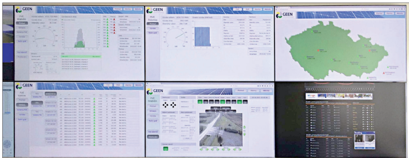
Obr. 1. Videostěnu dohledového centra tvoří osm velkoplošných obrazovek, o zobrazovanou grafiku a obsah se stará Foxtrot
