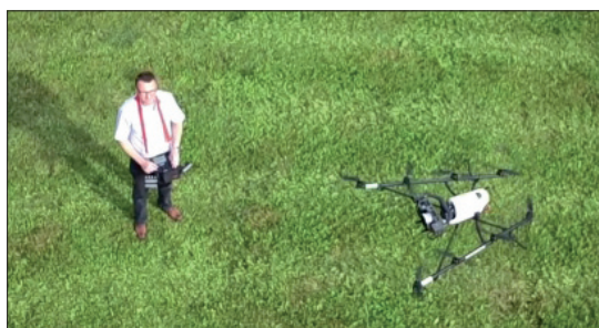
Obr. 3. Pro účely pořizování snímků střech a fasád objektů musí být dron za letu přesně a spolehlivě říditelný, což je třeba předem důkladně ověřit (foto: Siemens AG)
