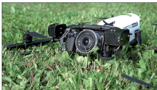
Obr. 2. Digitální monitorování umožňuje výkonná kamera vybavená speciálním softwarem pro analýzu obrazů (foto: Siemens AG)
