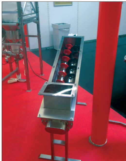
Obr. 5. Dopravník s dvojitou spirálou ve stánku společnosti RATAJ a. s.
