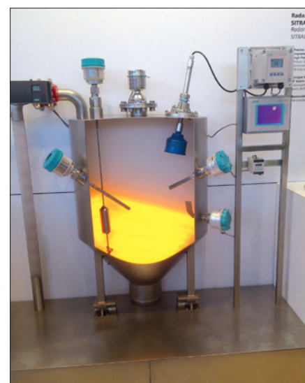
Obr. 3. Různé principy měření polohy hladiny v zásobnících ve stánku společnosti Siemens
