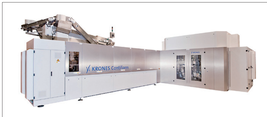
Obr. 1. Společnost Krones reaguje na neustále rostoucí požadavky na výkon strojů dosažením nového rekordu: každá vyfukovací stanice stroje Contiform 336 zpracuje 2 250 lahví za hodinu
