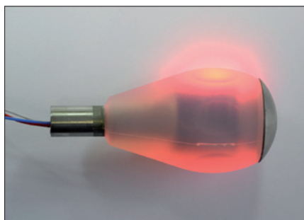
Obr. 1. Elektronická rukojeť pro chirurgické nástroje (foto: Fraunhofer IPA)
