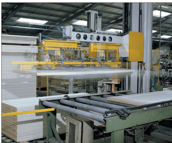
Obr. 1. Zpracování dřeva představuje typické prostředí s nebezpečím výbuchu prachu
