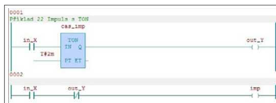
Obr. 42. Impuls generovaný časovačem TON (k příkladu 22)
