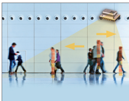
Obr. 1. Snímač pohybu Grid-EYE se uplatní při počítání lidí na letištích, nádražích či v městské dopravě
