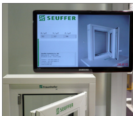
Obr. 2. Na monitoru jsou zobrazeny hodnoty magnetického pole a obrázek otevřeného okna
