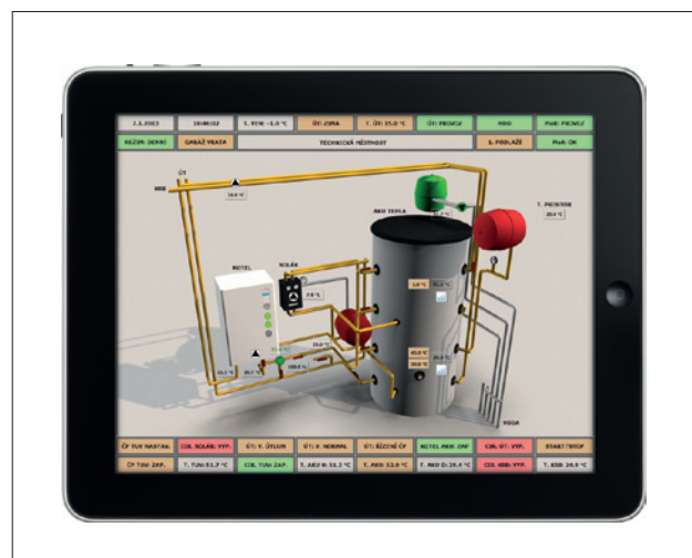
Obr. 4. Detail technické místnosti se stratifikační nádrží
