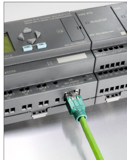
Obr. 3. Základní jednotka LOGO! OBA7 – slot pro kartu SD a ethernetový port RJ45
