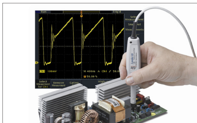
Obr. 1. Sonda I-Prober 520 pro měření proudu na deskách plošných spojů
