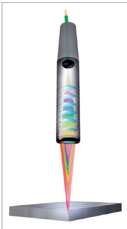
Obr. 2. Princip měření vzdálenosti konfokálně-chromatickým snímačem
