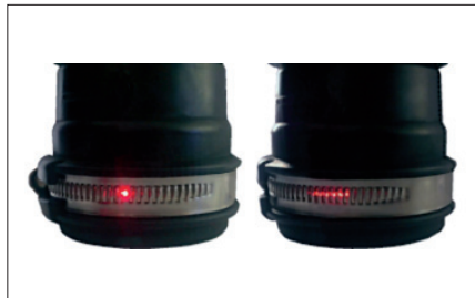
Obr. 5. Světelnou stopu lze zaostřit do kruhového bodu (vlevo) i do úsečky (vlevo); pro kontrolu umístění kovových spon se druhé řešení ukázalo jako vhodnější
