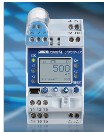
Obr. 3. Bezpečnostní teplotní omezovač a hlídač teploty JUMO safetyM STB/STW Ex
