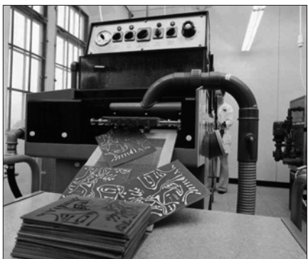
Obr. 2. Tranzistory místo trubek – výroba desek plošných spojů v roce 1960
