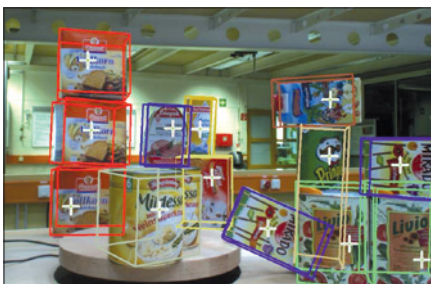
Obr. 1. Zjišťování polohy a orientace objektů v prostoru podle význačných (markantních) bodů (zdroj: Fraunhofer IPA)
