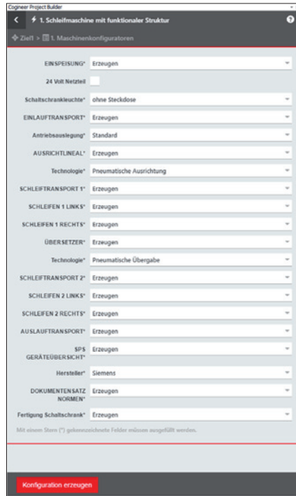
Obr. 4. U projektu brusky se zobrazuje kompletní funkční struktura a úplnou projektovou dokumentaci lze vytvořit jediným stisknutím tlačítka na základě všech možných variant stroje
