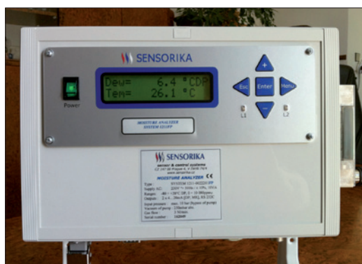
Obr. 2. Analyzátor vlhkosti System 1211FP, čelní pohled (zleva: vypínač napájení, displej, ovládací tlačítka a kontrolky; vpravo na boku plovákový průtokoměr)
