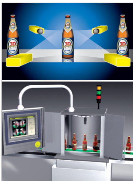
Obr. 1. Ze čtyř obrazů získaných z kamer v různých pozicích je vytvářen dokonalý celkový pohled v rozsahu 360° na etiketu láhve
