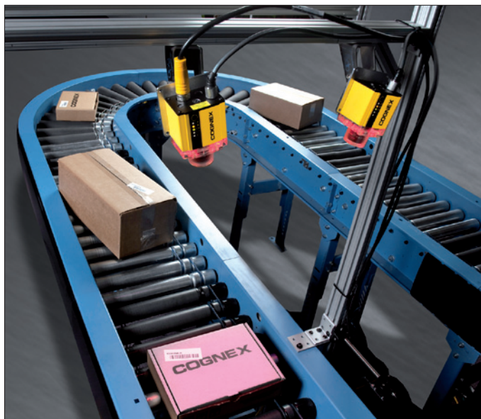
Obr. 4. Přístroje DataMan pro čtení a vyhodnocování identifikačních kódů umožňují nepřetržitě sledovat konstrukční díly a produkty v průběhu výroby a také produkty zpětně vysledovat
