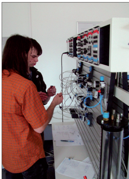
Obr. 1. Studenti zapojují prvky stavebnice Festo Didactic v úloze s použitím pneumatického řídicího signálu
