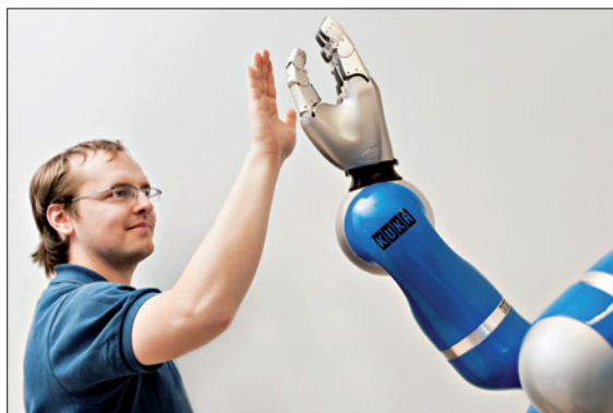
Obr. 1. Kolaborativní roboty mohou díky citlivým snímačům bezprostředně spolupracovat s člověkem (foto: Daimler und Benz Stiftung)
