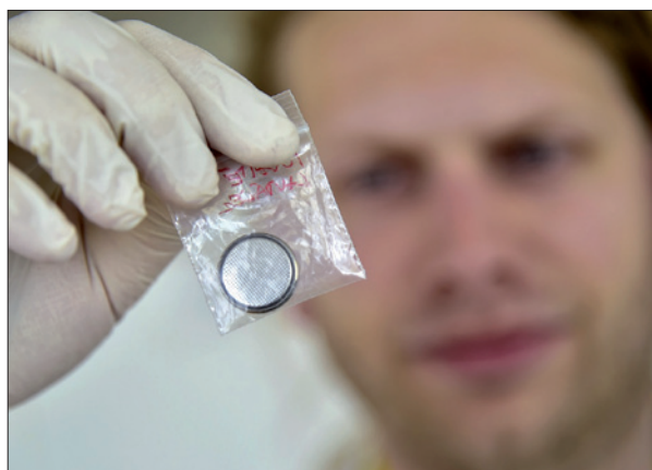
Obr. 1. Vývoj Li-S baterií byl na FEKT VUT završen podáním evropského patentu a výrobou prototypu knoflíkové baterie (foto: VUT Brno)
