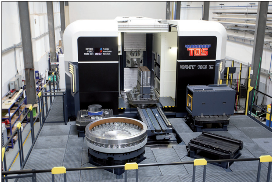
Obr. 2. Horizontální vyvrtávací a obráběcí stroj typu WHT 110 ze soudobé produkce TOS Varnsdorf
