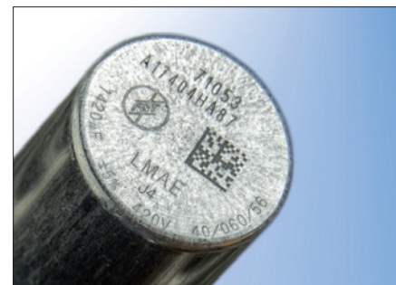
Obr. 2. Laserem vytvořený popis s individuálními parametry na čele kondenzátoru
