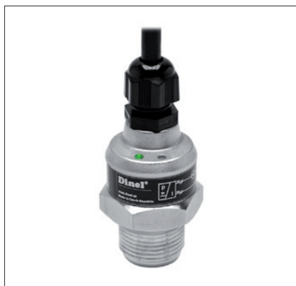
Obr. 2. Hydrostatický hladinoměr HLM-35 s polozapuštěným převodníkem a závitovým připojením
