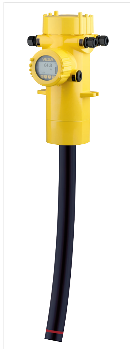
Obr. 2. Tyčový zářič FT31 se používá tam, kde není možné umístit zářič vně nádrže, protože by záření bylo při průchodu médiem příliš zeslabeno
